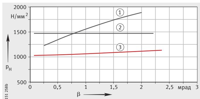
Опорный ролик NUTR15, сопряженная дорожка качения из стали 42CrMo4V с твердостью 350 HV, рис. 3.
